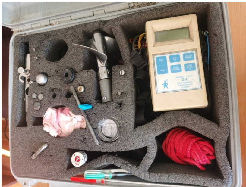
รูปที่ 3 ตัวอย่างเครื่องวัดกระแสไฟฟ้าที่ใช้ในศูนย์อุทกวิทยาชลประทานภาคเหนือตอนบน
